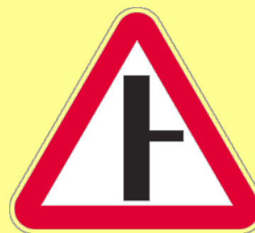
Примыкание второстепенной дороги
